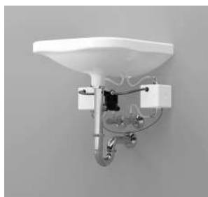
2 dispositivos HygBox para agua fría y caliente (necesario pedir 2 uds. 2622.15.000) con set de conexión 2 Box (2622.00.902) y set de conexión sifón (2622.00.900)
