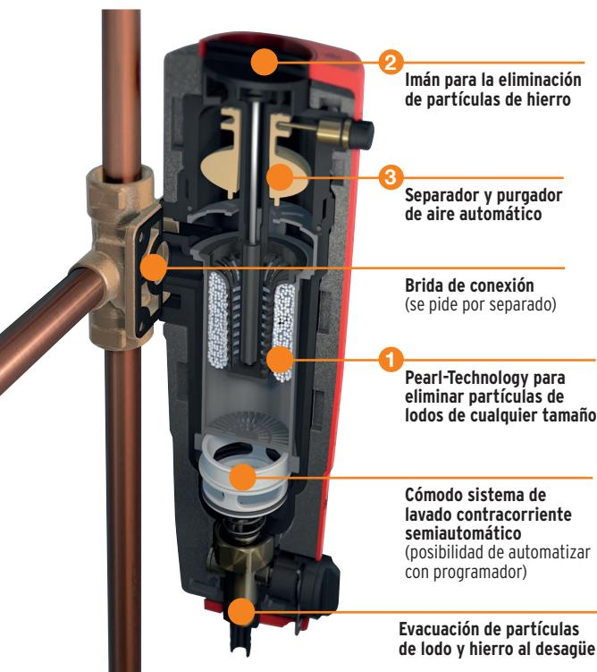
Los lodos y las partículas férricas en el agua de los sistemas de calefacción/ climatización reducen la eficiencia energética y dañan los intercambiadores de las calderas y bombas de calor. El filtro multifunción 3 en 1 HF 3415 protege sus equipos eficazmente.
