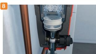
Extraiga el imán de la vaina. Abra la válvula de bola para activar el lavado contracorriente. La cesta con las perlas sintéticas descenderá y el agua limpia del lavado arrastrará los lodos y partículas férricas hacia la salida de desagüe ofreciendo así una limpieza cómoda y eficaz.
